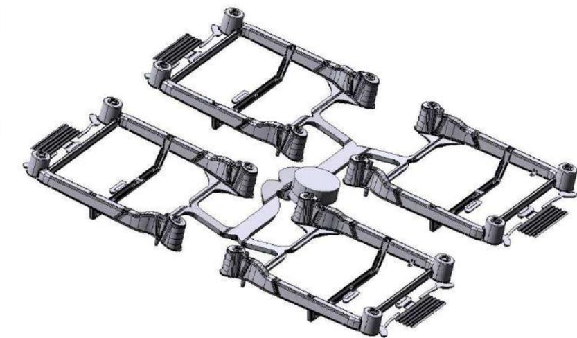
Nr. 03 cavity trimming tool for MAGNESIUM
