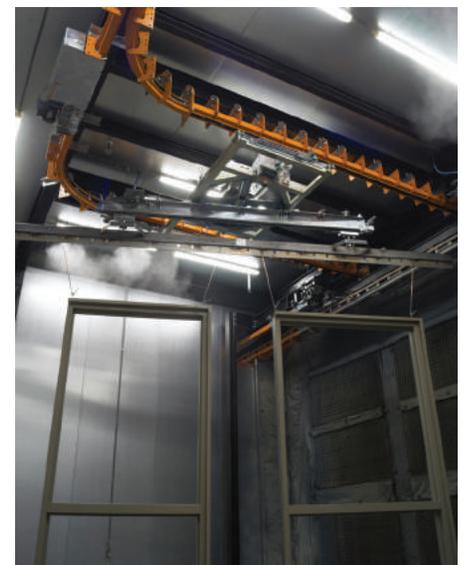
Die Produkte können mit Barcode-/RFID-Tags versehen werden, so dass sie während des Durchlaufs durch die Lackier- und Trockenbereiche verfolgt werden können. Dies wird über die Touchscreen-Panels am Schaltschrank visualisiert, was es einfach macht, Anpassungen vorzunehmen und den Bewegung des Produkts entlang des Systems zu verfolgen.
