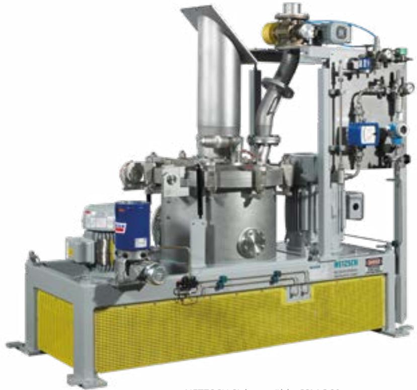
NETZSCH Sichter­mühle CSM 360
