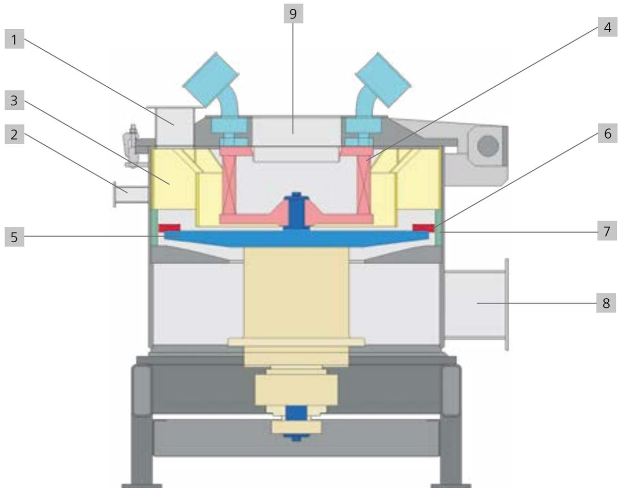
Das Mahlgut wird gravimetrisch über das Fallrohr (1) oder pneumatisch über einen Injektor am Gehäusestutzen (2) zugeführt. Das Mahlgut gelangt dann innerhalb des Leitringes (3), vorbei am Schaufelsichtrrad (4), wo bereits vorhandenes Feingut ausgesiebt wird, zum Schlagrotor (5), wo es von den Schlägern (6) erfasst, beschleunigt und gegen die Mahlbahn (7) geschleudert wird.
