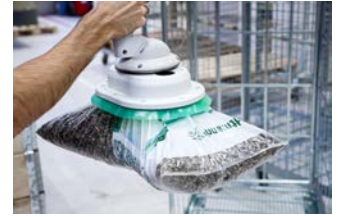
Einsatz für automatisiertes Handling am Roboter oder manuelle Handhabung mittels Vakuumschlauchheber
