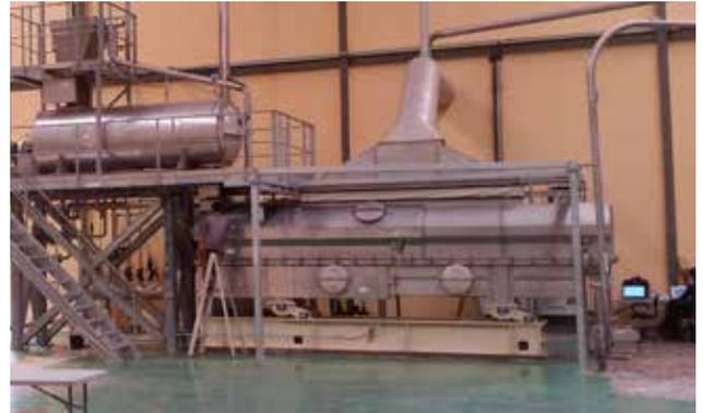
Sterilisations- / Trocknungsanlage für Gewürze, Indonesien
