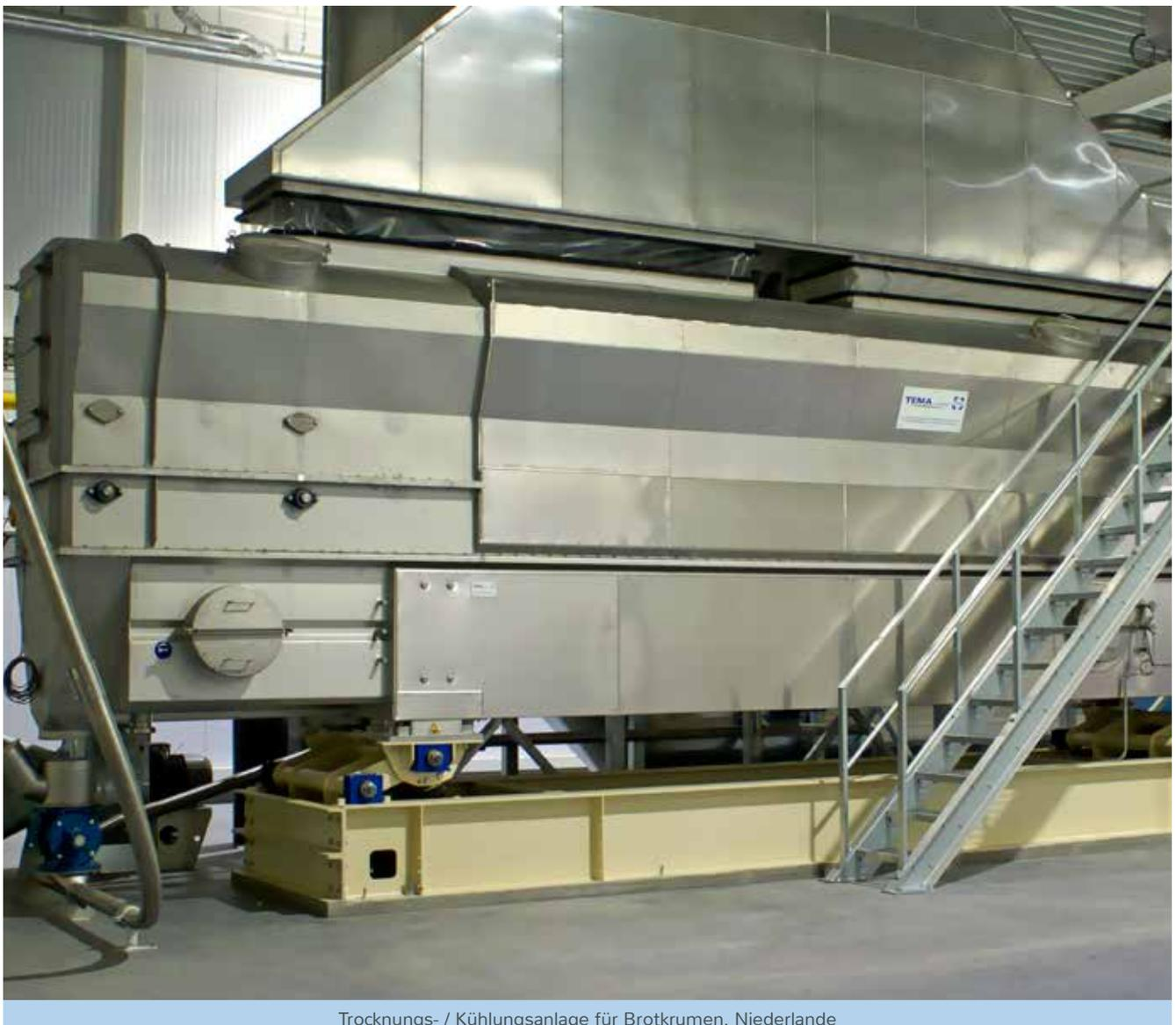
Trocknungs- / Kühlungsanlage für Brotkrumen, Niederlande
