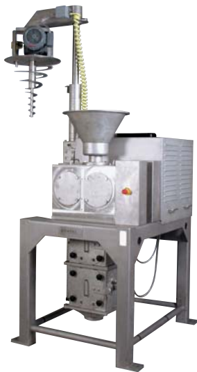
RC 250 mit pneumatischer Hubsäule und zwei Rotorsiebmaschinen
