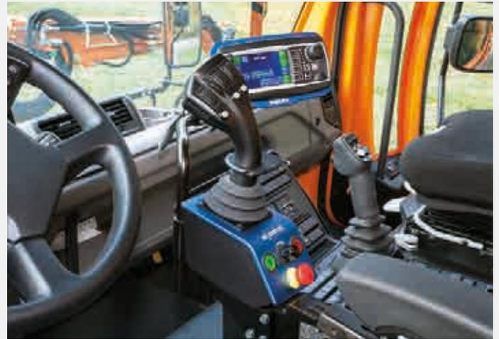
Multifunktions-Joystick m|pilot mit 6-facher Proportionalsteuerung
