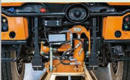
Vom Fahrerhaus zuschaltbare hydraulische Vorderachsverriegelung, die eine Fahrzeugverwindung (einseitige Einfederung) während des Mähbetriebs verhindert. Ein weiteres Sicherheitsplus für den Bediener.
