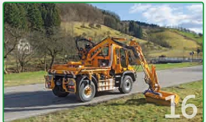
Mit unseren Heckauslegergeräten nutzen Sie den Aufbau Raum des Unimog optimal aus und erhalten Reichweiten bis zu 8,7 m.
