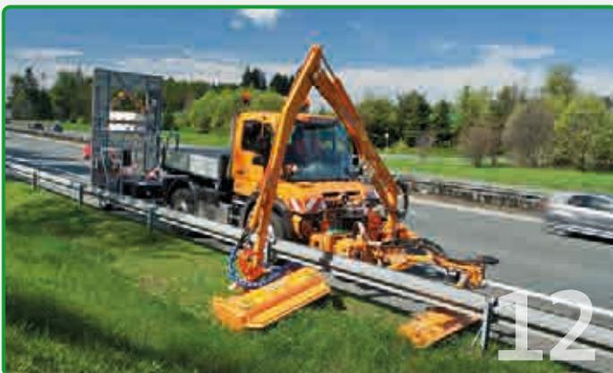
Unsere Auslegerkombinationen sind optimal für den Ein-Mann-Betrieb zur gleichzeitigen Durchführung von zwei Mähschnitten.
