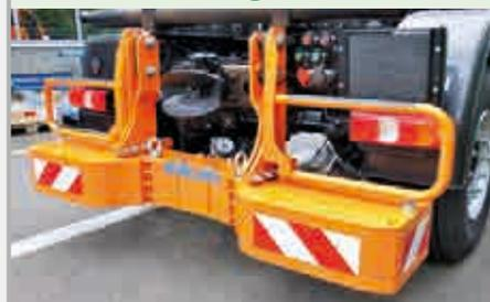
Ein von MULAG entwickeltes Ballastgewicht mit spezieller Formgebung ist auch für den Kombinationsbetrieb mit aufgebautem Streuautomaten geeignet.
