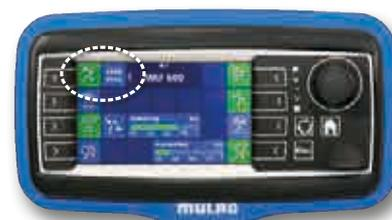
Mit Hilfe eines Sensors an der Messerwellenlagerung wird die aktuelle Messerwellendrehzahl erfasst und auf dem Bedienteil angezeigt. Bei Überschreitung eines Maximalwertes erfolgt eine Warnung.
