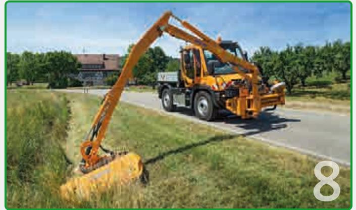
Unsere Frontauslegergeräte ermöglichen einen flexiblen Einsatz bis zu einer Reichweite von 7,4 m.
