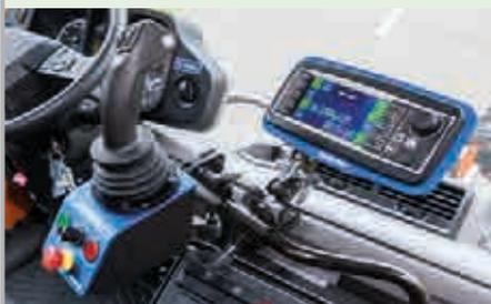
Die Passform dieses Bedienteils ist ergonomisch optimal auf die Handform des Menschen abgestimmt. Es sind bis zu vier Proportionalfunktionen auf einer Ebene steuerbar.
