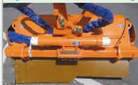
Der Verstellbereich beträgt 230 Grad und ist stufenlos über das Bedienpult steuerbar. Die Verstellung kann während des Arbeitsvorgangs erfolgen und ist variabel einstellbar.
