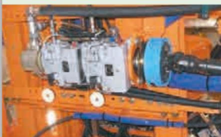
Der Antrieb für die Heckmähgeräte kann alternativ über den Motornebenantrieb Code N05 erfolgen. Das Mähgerät ist dadurch hydraulisch völlig unabhängig vom Trägerfahrzeug.
