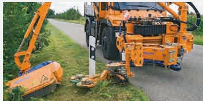
Leitpfostenausmäher im Wechselanbau am Kombinations-Mähgerät
