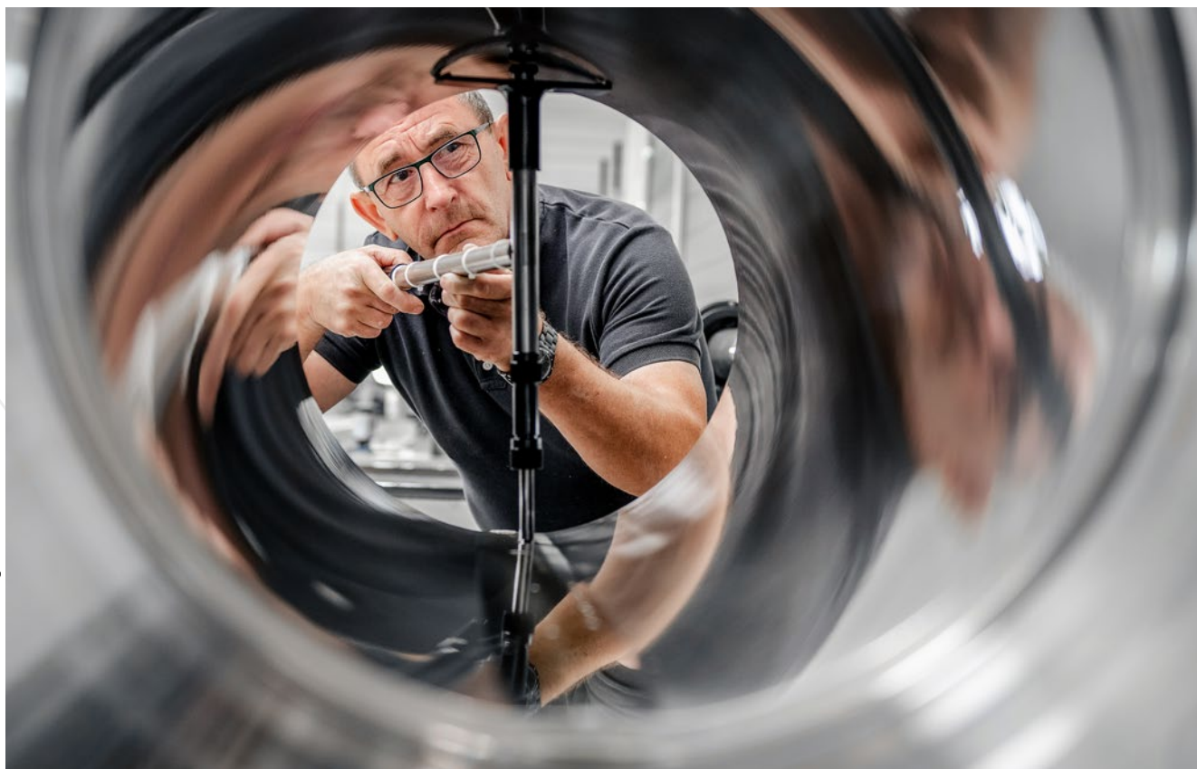
Durchmesserkontrolle der gehonten Laufbuchse
