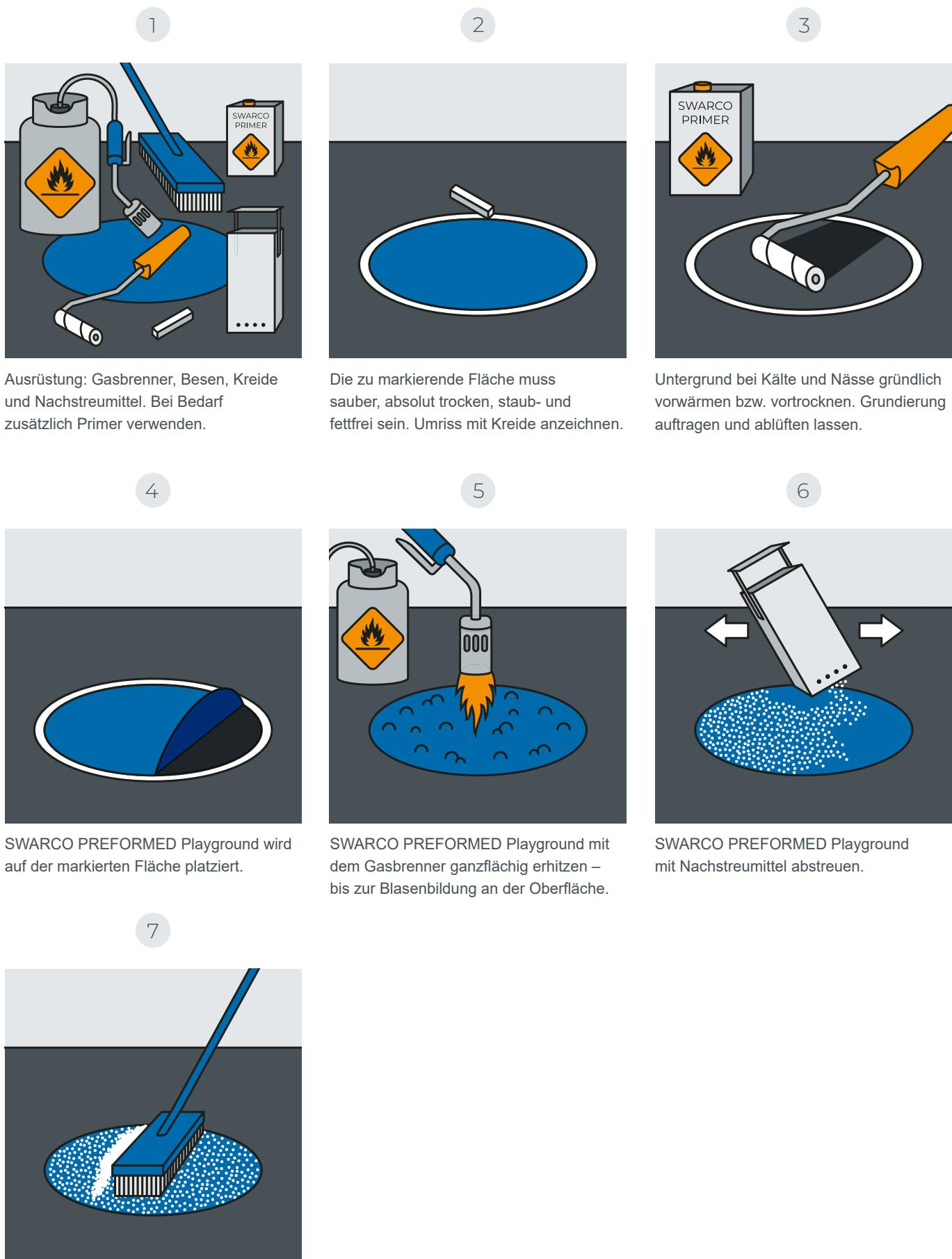
Mit dem Besen reinigen und die Haftung mit einem spitzen Gegenstand prüfen. Schon nach wenigen Minuten ist die Markierung einsatzbereit.
