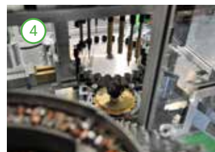
Monitoring with photocells and proximity Monitoraggio con fotocellule e prossimità
