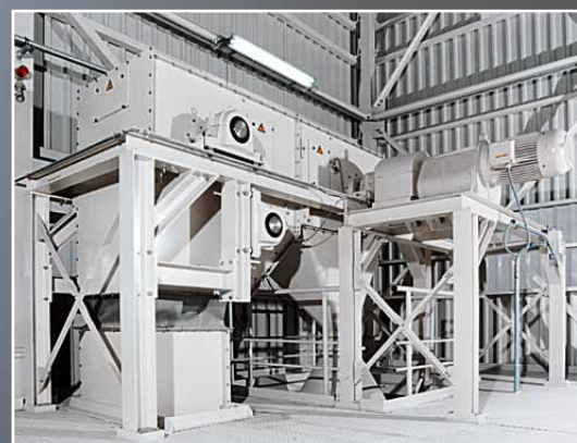
Abgabestation eines WB 640 mit 30 kW-Antrieb
