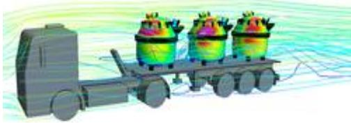
In dem Projekt, das Teil des bayerischen Forschungsverbundes FORETA war, wurde der Energieverlust beim Flüssigaluminiumtransport über große Strecken mit LKWs untersucht. Dies geschah mit einer Kopplung von Strömungs- und Prozesssimulation, um die thermischen Verluste der Transportbehälter zu ermitteln. Die Ergebnisse wurden durch Messergebnisse von Transportfahrten validiert.
