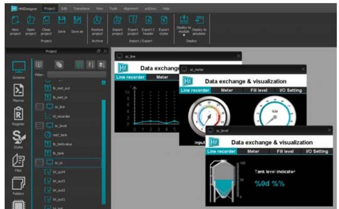
Modbus-Kommunikation möglich. Die Übertragung von Werten, Touchbedienungen oder die Darstellung von Texten erfolgt über frei definierbare Modbus-Register. Auch Fließkommazahlen können direkt übertragen und dargestellt werden. Selbst Mehrsprachigkeit wird unterstützt. Im HMI-Designer sind ausserdem viele weitere Hilfsmittel integriert wie z.B. ein Debugger, ein Modbusterminal, ein Dokumentationstool, ein Tool für Hardcopy, Projektver schlüsselung u.s.w.
