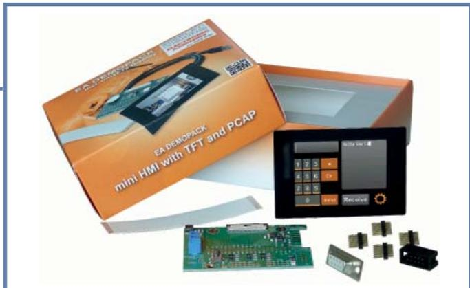
los) eindrucksvolle Touch- und Anzeigefunktionen sowie elegante Bedienkonzepte zu realisieren. Alle dargestellten Objekte können animiert werden und lassen sich während der Laufzeit in Form, Farbe und Inhalt ändern. Der eingebaute Flash-Speicher fungiert als Ablage für Bilder, Fonts, Menüs und Log-Files. Für akustische Aufmerksamkeit sorgt die eingebaute Audioausgabe.
