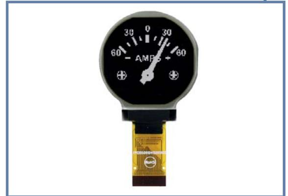
Stunden. Selbst bei einer dauerhaft extremen Betriebstemperatur von +80°C erzielen sie nach 14.000 Betriebsstunden immer noch 50 Prozent ihrer ursprünglichen Helligkeit. Die Displayfamilie EA OLEDxxx ist dank integrierter Pins im Raster 2,54 mm besonders einfach einzusetzen. Über die Montage muß man sich keine Gedanken mehr machen.
