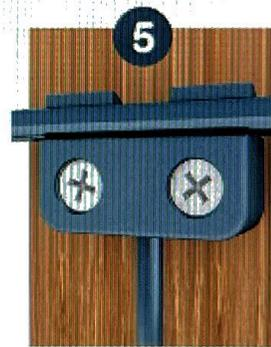
**5** Die vorgebohrten Löcher nehmen die Schrauben auf, wobei die Länge der Schrauben sich nach der Sichtblendenstärke richtet.
