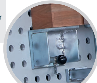
Einzelaufgabe fest, mit 2 Rastbolzen Fixed single support, with 2 matrix bolts
