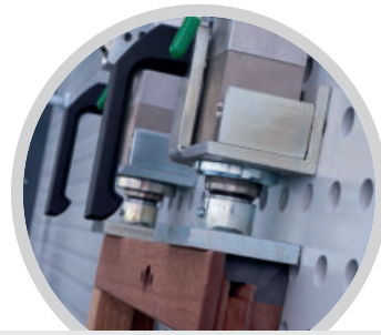
Konterprofilzulage mit Haltemagnet Counter profile with holding magnet
