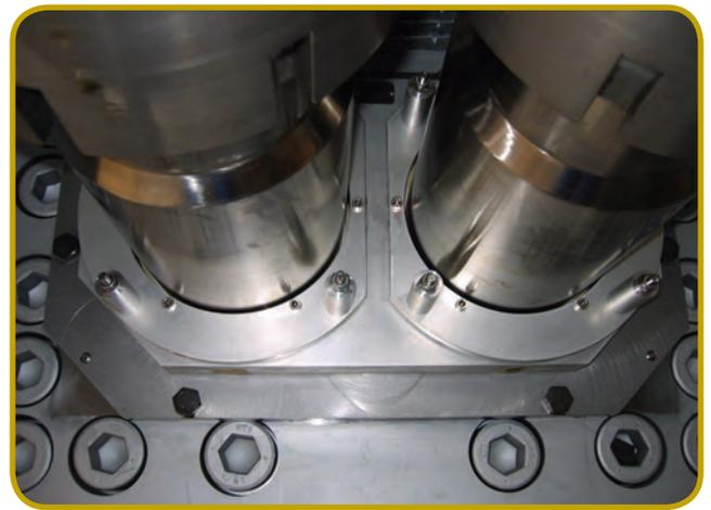
**MECO-DOPPELDICHTUNG IN EINEM COPERION-EXTRUDER ZSK-380**
