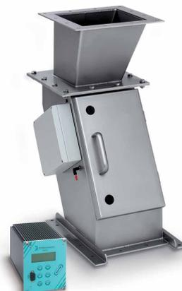
Die **DYNAscale** ist eine einzigartige Rutschenwaage, die eine berührungslose Geschwindigkeitsmessung mit bewährter Wägetechnik verbindet. Ähnlich dem Bandwaagen-Prinzip wird unabhängig voneinander das Gewicht sowie die Fließgeschwindigkeit des Schüttgutes gemessen und in Freifallanwendungen hochpräzise zum Massedurchsatz verrechnet.
