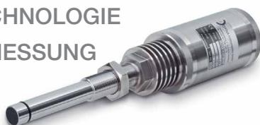
Ausgestattet mit modernster Mikrowellentechnologie wird der **DYNAmflow** zur Durchflussmessung von Feststoffmengen in metallischen Rohrleitungen eingesetzt. Schüttgüter aller Art können im Durchsatzbereich von wenigen kg/h bis zu vielen t/h reproduzierbar gemessen werden.
