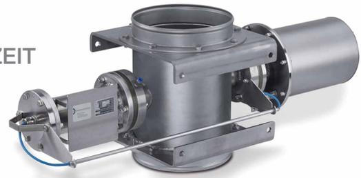
Der **DYNAsize** ist ein Messgerät zur kontinuierlichen Bestimmung der Partikelgröße von frei fließenden Schüttgütern zwischen 170 und 6000 µm. Dazu ist es nicht notwendig, Proben zu entnehmen, denn die Messung findet direkt im Prozess und in Echtzeit statt.
