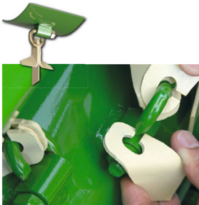
Werkzeugloser Umbau auf Vertikutieren – schnell gemacht
