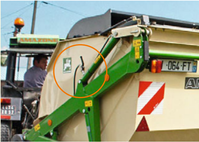
Hydraulische Zylindersperre für Grasshopper-Typen mit Hochkippentleerung
