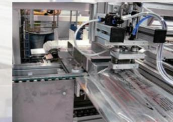
Befüllung mit Roboter/Handlinggeräten
