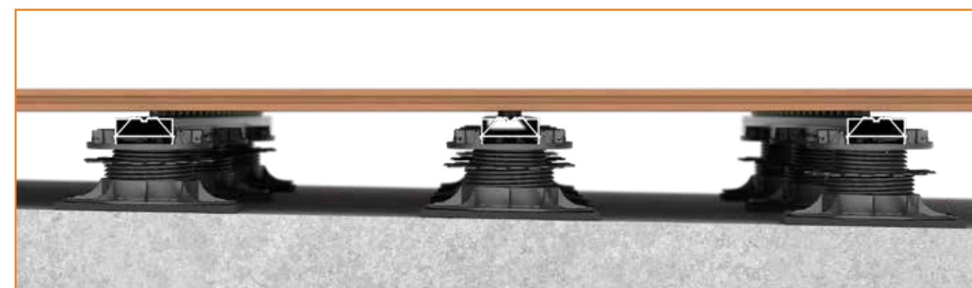
Verlegung ohne Gefälle
