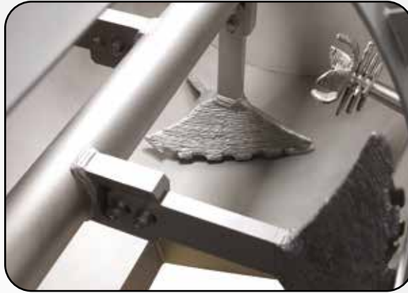
Pflugscharwerkzeuge mit Schweißauftragung
