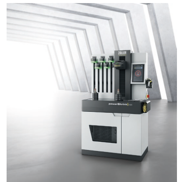
Bild 4: Die neuentwickelte Schrumpfgeräteserie »powerShrink 400/600« für das Schrumpfen von Werkzeugen mit optimaler Energieeffizienz und maximaler Sicherheit.
