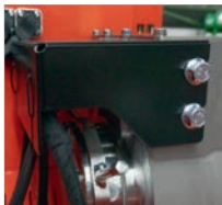
Bürstenlose und somit wartungsfreie Elektromotoren
