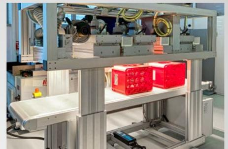
*Trocknung mit einem „Multiple-IR-Curing“-NIR-Modul.*
