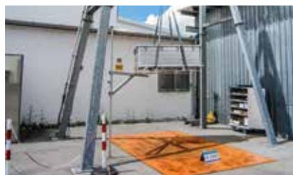
ZARGES ist als autorisierte Prüfstelle berechtigt und in der Lage, Gefahrgutverpackungs-Prüfungen durchzuführen und die Bauartzulassung zu beantragen.
