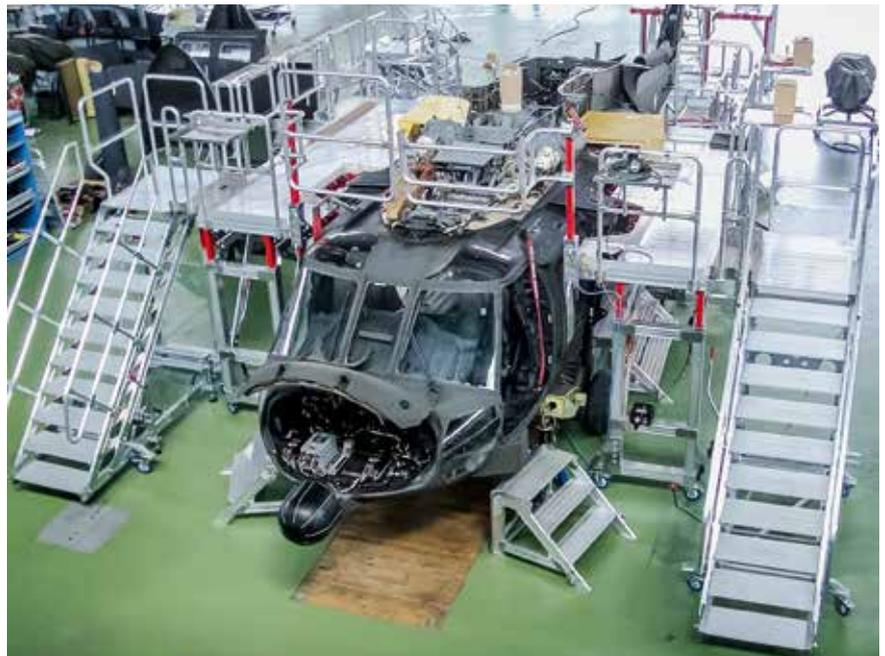
Höhenverstellbare Arbeitsbühnen mit Konturanpassungen für optimale Wartungsarbeiten
