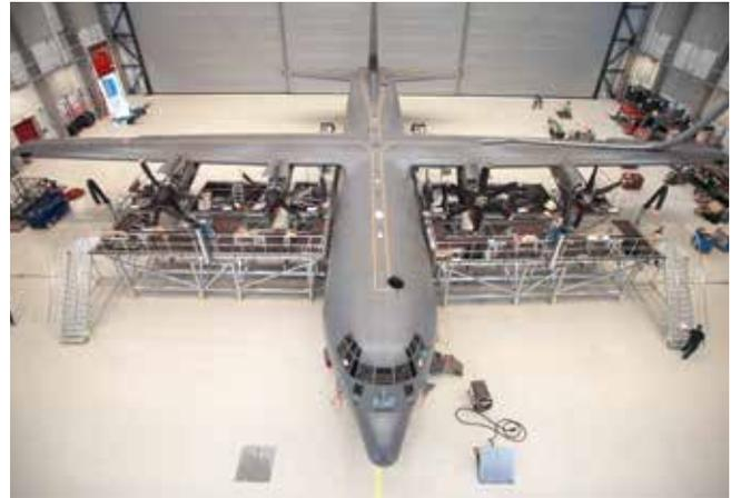
Fahrbares Propeller-Dock für Wartungs- und Reparaturarbeiten an der LOCKHEED C-130 HERCULES
