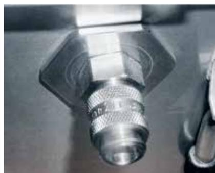
VA-Befüll- und Entleerventil für Schutzgasbefüllung
