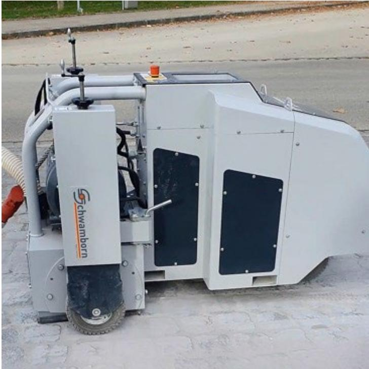
Die neue Fräs- und Schneidemaschine BEF 400RC ermöglicht das barrierefreie Einebnen von gepflasterten Wegen, Straßen und Plätzen.
