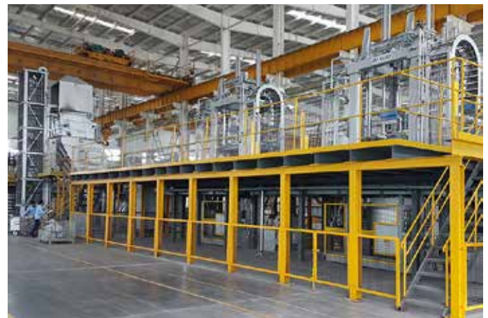
Gießelinie mit Bühne, Warmhalte- und Entgasungsstation für die Produktion von Strukturteilen
