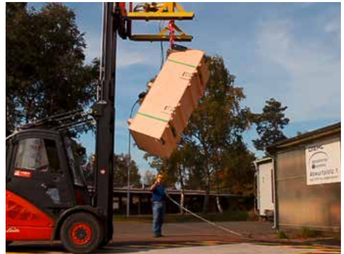
Falltest einer Lithium-Ionen-Batterieverpackung Drop test of a Lithium-ion battery packaging
