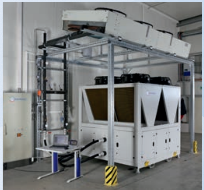
Hauseigener Maschinenprüfstand für Testzwecke und die stetige Weiterentwicklung der Maschinen. Neuentwickelte Regelkonzepte können von uns umfangreich getestet werden.
