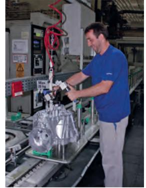
Anstrengungsfrei: Mit dem BalanceLift kann Mario Xourgias das Getriebegehäuse vom hohen Gitterwagen über die Kante zum niedrigen Montageband mit Leichtigkeit bewegen.
