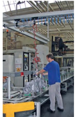
Der BalanceLift in Kombination mit dem Schienensystem BalanceRail ermöglicht es, in der Getriebefertigung der Volkswagen AG hohe Stückzahlen effizient und für die Mitarbeiter ergonomisch und sicher zu produzieren.
