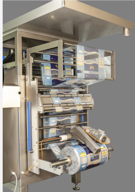
Motorisch angetriebene Folienabwicklung . Schneid- und Klebetisch für schnellen Folienwechsel.
