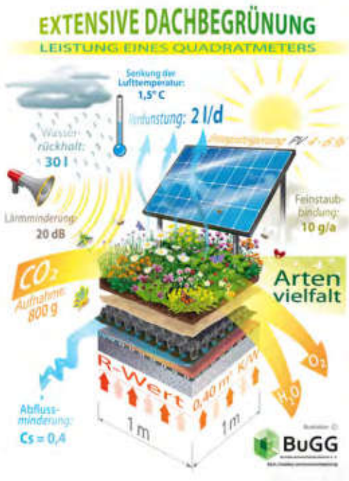
Abb. 68: Das kann ein Quadratmeter eines optimalen Solar-Gründachs leisten. Quelle: BuGG
