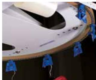
Das VEIT Transporthaken-System mit der breiten Auflagefläche des Kleiderbügels sorgt für einen ruhigen Transport auch bei hoher Geschwindigkeit.
