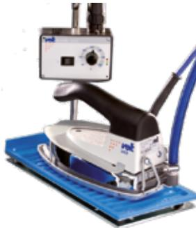
Durch die spezielle Ausformung des Unterschuhs kann ein Hosenbein in einem Pressvorgang gefinisht werden. Das Bezugssystem und die variable Druckeinstellung vermeiden unnötige Abdrücke.
