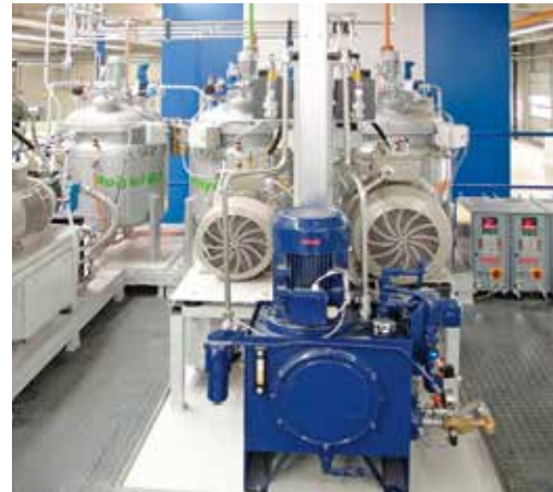
Vollautomatische Hochdruckdosiermaschine für PUR-Schaum
