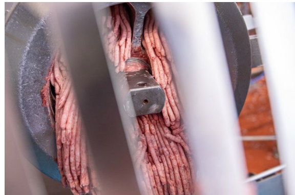
IMG_7843 und IMG_7860: Die Schälkante der Zubringerschnecke schneidet gefrorene und – hier im Bild – knochenhaltige Zutaten vor, ohne sie zu quetschen. Zugleich fördert sie das Material durch variabel einstellbare Geschwindigkeiten schonend Richtung Fleischschnecke. Das Ergebnis: ein erstklassiges Schnittbild.
