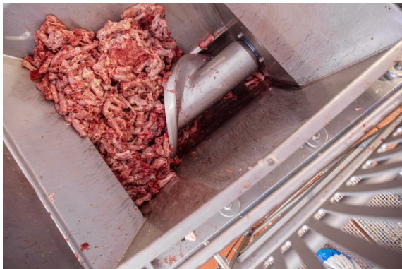
IMG_7843 und IMG_7860: Die Schälkante der Zubringerschnecke schneidet gefrorene und – hier im Bild – knochenhaltige Zutaten vor, ohne sie zu quetschen. Zugleich fördert sie das Material durch variabel einstellbare Geschwindigkeiten schonend Richtung Fleischschnecke. Das Ergebnis: ein erstklassiges Schnittbild.
