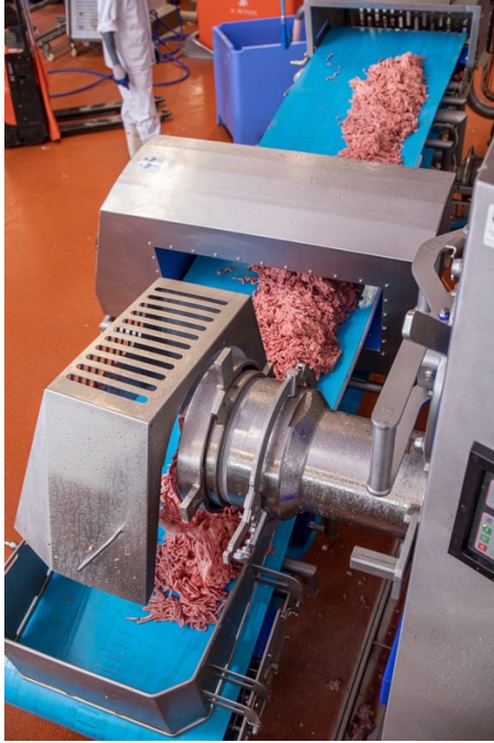
IMG_7854: Die Vorschneider-Stützeinrichtung reduziert den Druck auf den Schneidsatz erheblich – für eine höhere Standzeit der Schneidsätze, reduzierte Schleifzyklen und ein stets erstklassiges Schnittbild.
