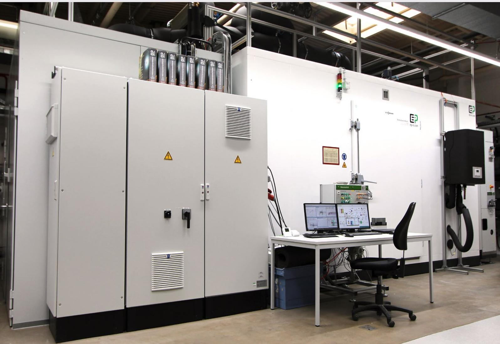
📍 HPT Wärmepumpenprüfstand bei STIEBEL ELTRON
