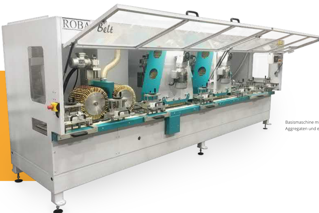
ROBA Belt Maschinenkonfiguration für die Bearbeitung von Fußbodenprofilen mit einem BA300 Bandschleifaggregat. Die SPS gesteuerte und motorische Oszillationsbewegung aller Aggregate berücksichtigt neben der Schleifband- auch die Werkstückbreite. Das stellt sicher, dass das Schleifpapier stets komplett genutzt wird.
