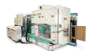
ROBA Tech Vertikal zum Schleifen von Türen, die in einem Fördersystem hängen
