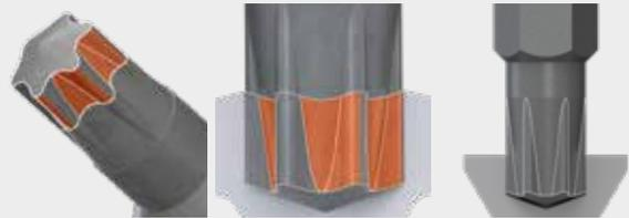
Der SIT®-Antrieb verbindet die Stärken eines Kreuzschlitz (konischer Kern) mit denen eines TX-Antriebes (große Kraftangriffsflächen).
