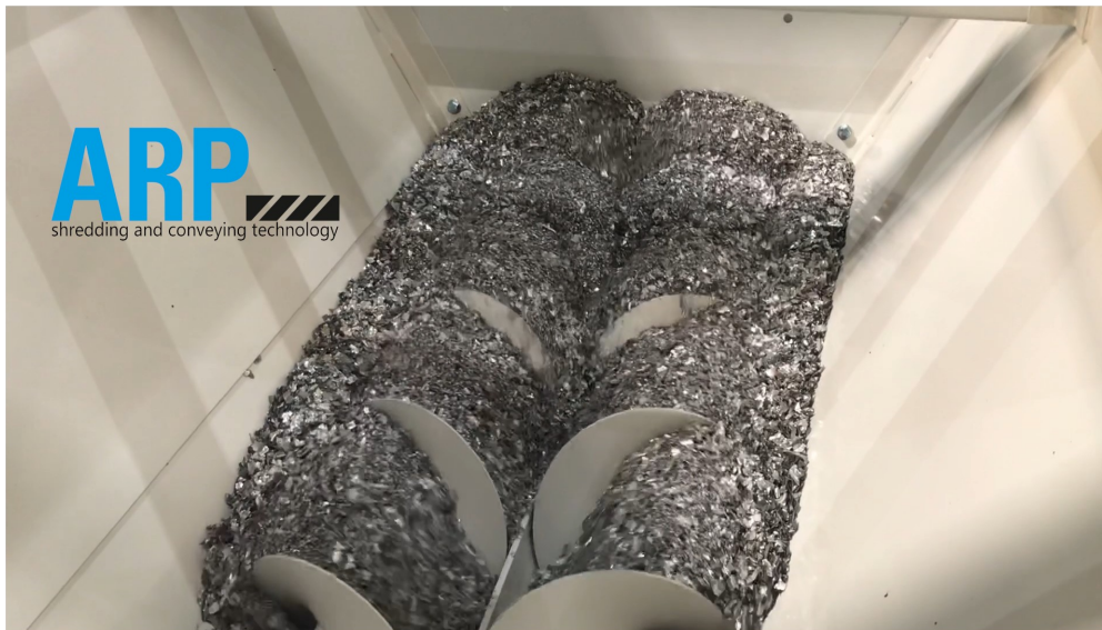
Blick in eine Doppel-Förderschnecke mit Speicherfunktion. Diese Dosierschnecke hat eine steuerbare Leistung von bis zu 6t/h.
