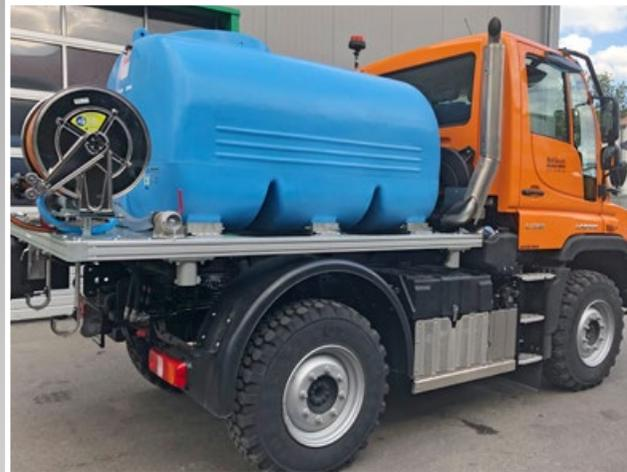
Unimog mit Gießanlage
