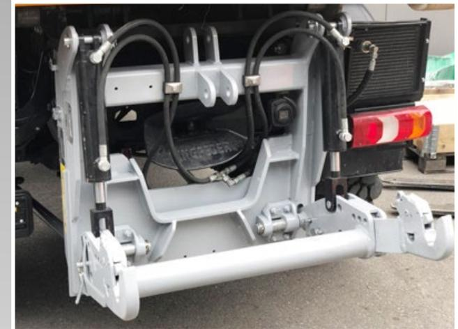
Heckkraftheber für Unimog
