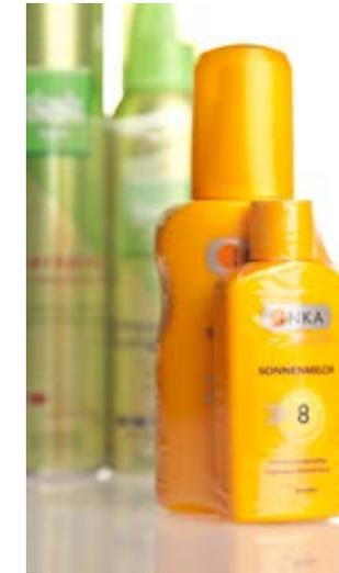
Zwei oder mehr Produkte werden mit einer Klarsichtfolie verbunden. Diese Verpackungsart ist auch für Einzelteile geeignet, die am Point of Sale noch nicht geöffnet werden sollen (z.B. Lippenstifte).
