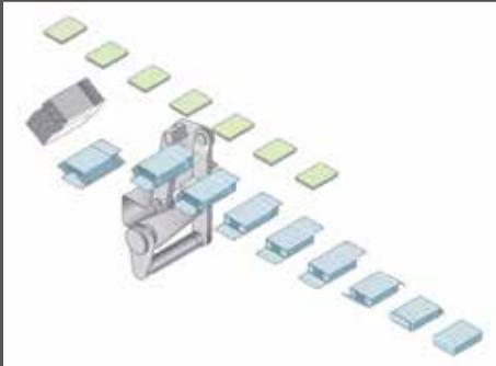
Zuführung für Handeinlage oder automatische Zuführungen
