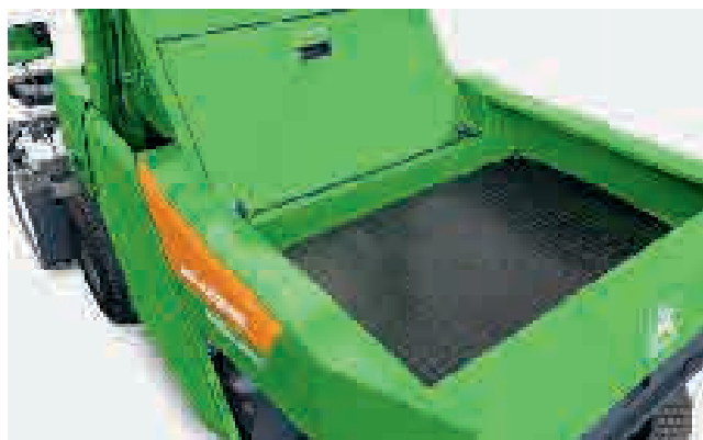
Pritsche des ProfiMowers mit 4 Zurrösen und einer hohen Bordwand für das Mitführen von Arbeitsmaterialien.
