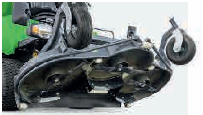
BladeCut-Sichelmähwerk mit 3 Rotormessern
