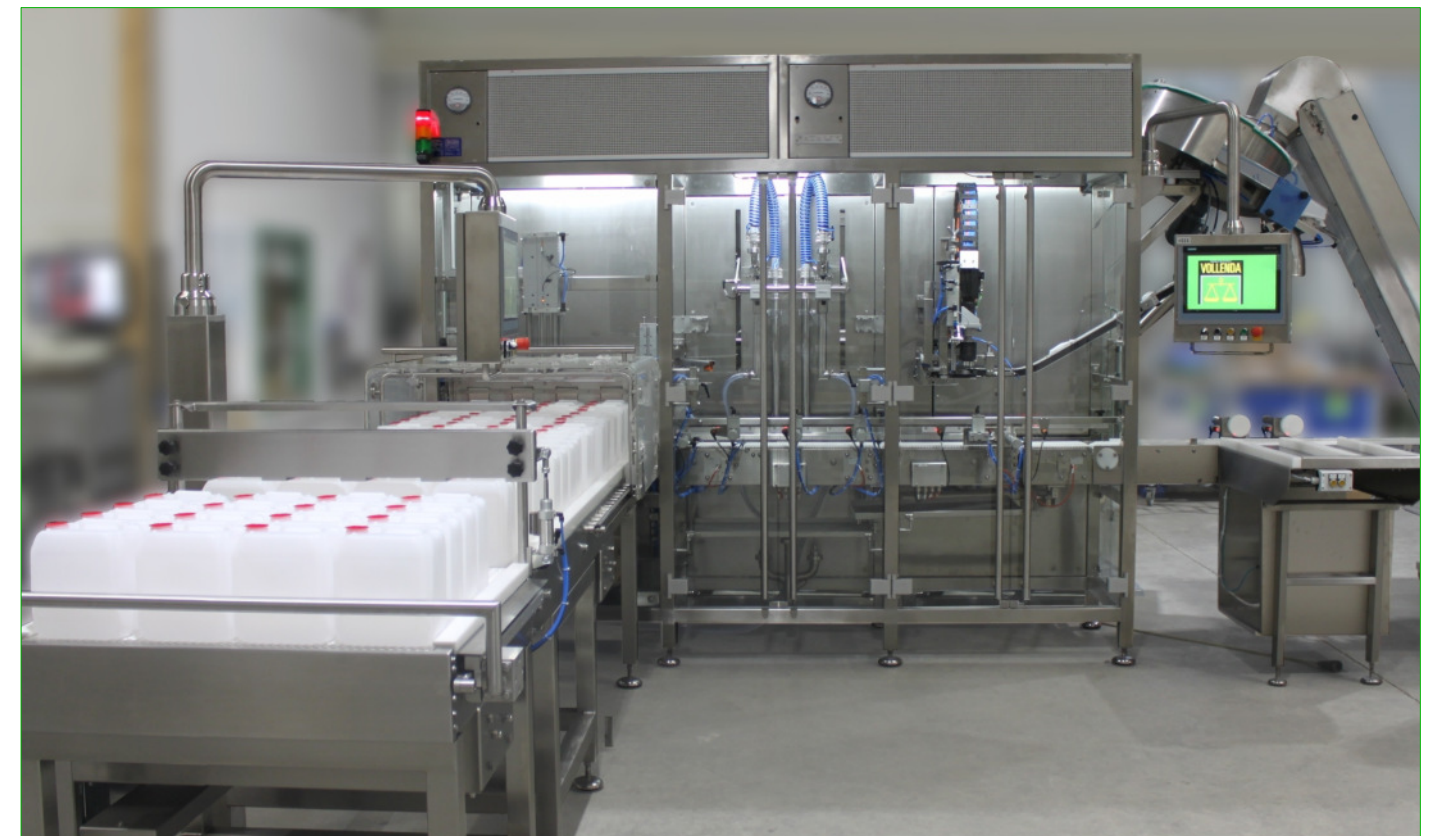
Vollautomatische Abfüllanlage in Hygieneausführung Compact fully automatic filling line in hygienic design
