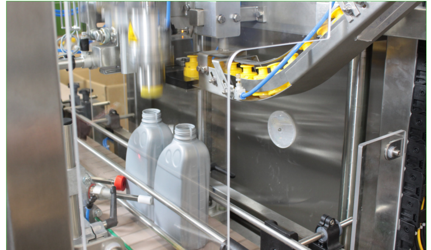
Vollautomatischer Verschleißer mit Drehmomentüberwachung Fully automatic capper with torque control
