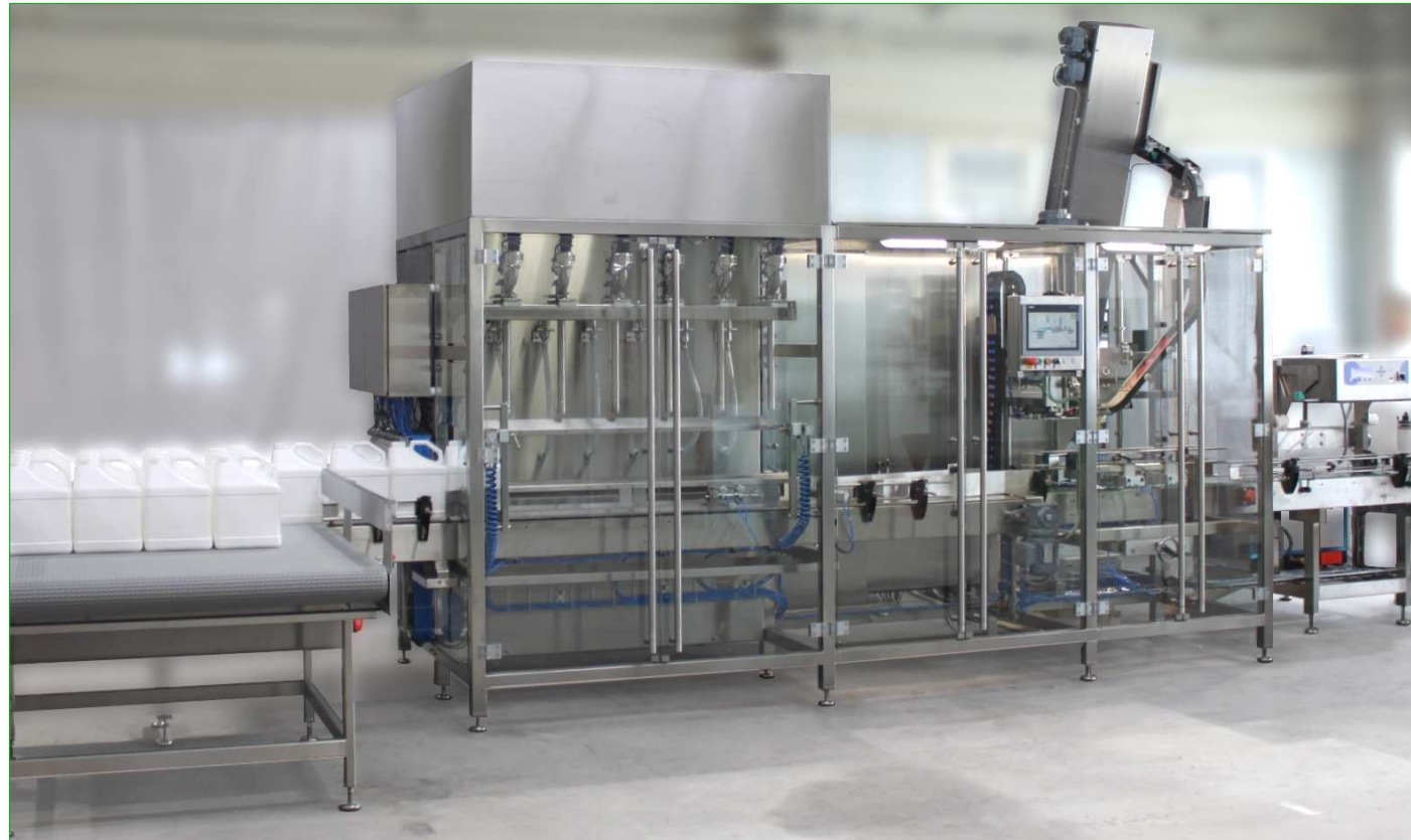
Vollautomatische Abfüllanlage für Kanister Fully automatic filling line for canisters
