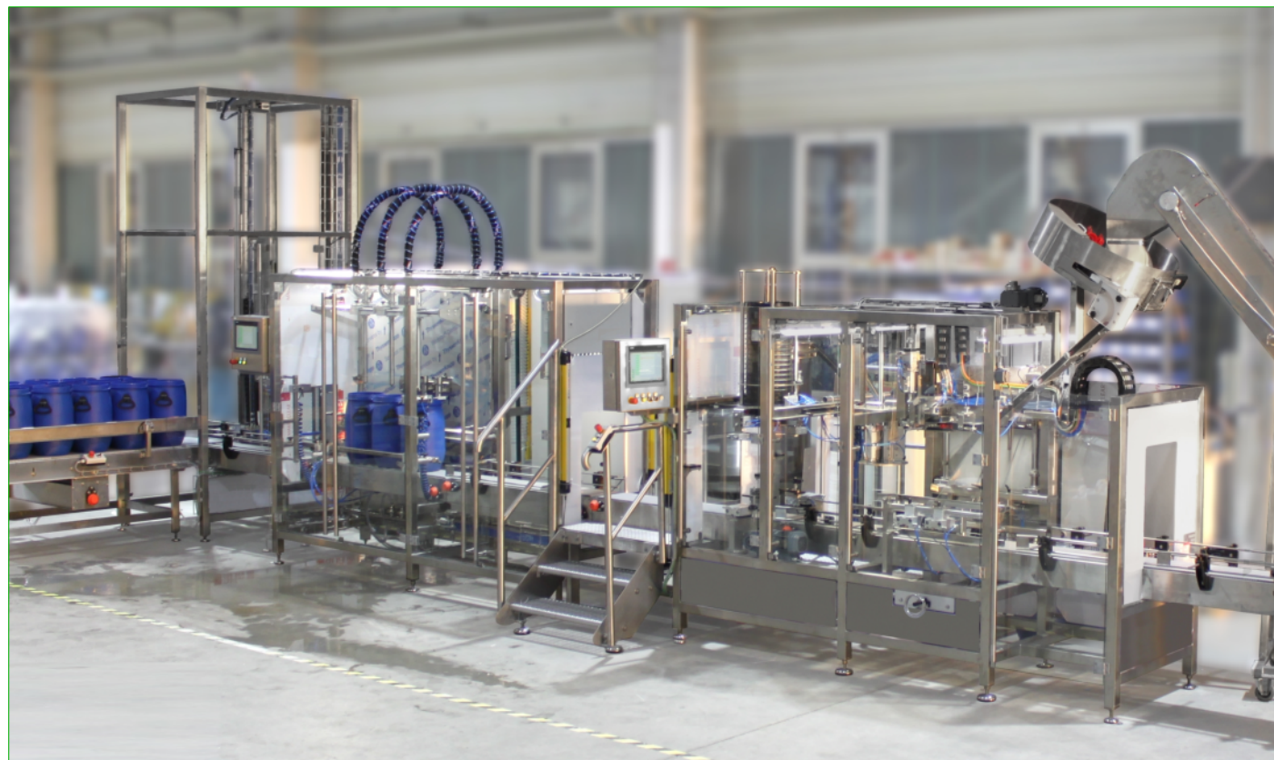
Vollautomatische Abfüllanlage für Fässer und Eimer Fully automatic filling line for drums and pails
