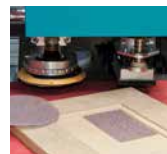
Rundes Schwing-schleifaggregat und rechteckiges Exzenter-schleifaggregat für verschiedene Aufgaben.
