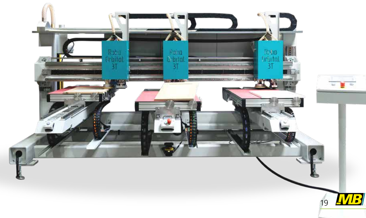
ROBA Orbital 3T mit drei unabhängig voneinander arbeitenden Vakuumtischen.
