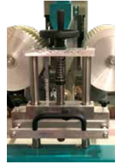
Das Vorschubsystem besteht aus gummierten Vorschubwalzen. Die seitlichen Anschläge und Oberdruckeinheiten sind zentral verstellbar
