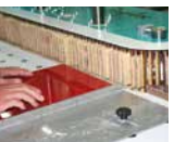
ROBA Duplex im Einsatz: Kantenschliff an Möbelfronten
