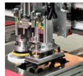
Füllungen von MDF-Fronten werden perfekt von Frässpuren befreit.
