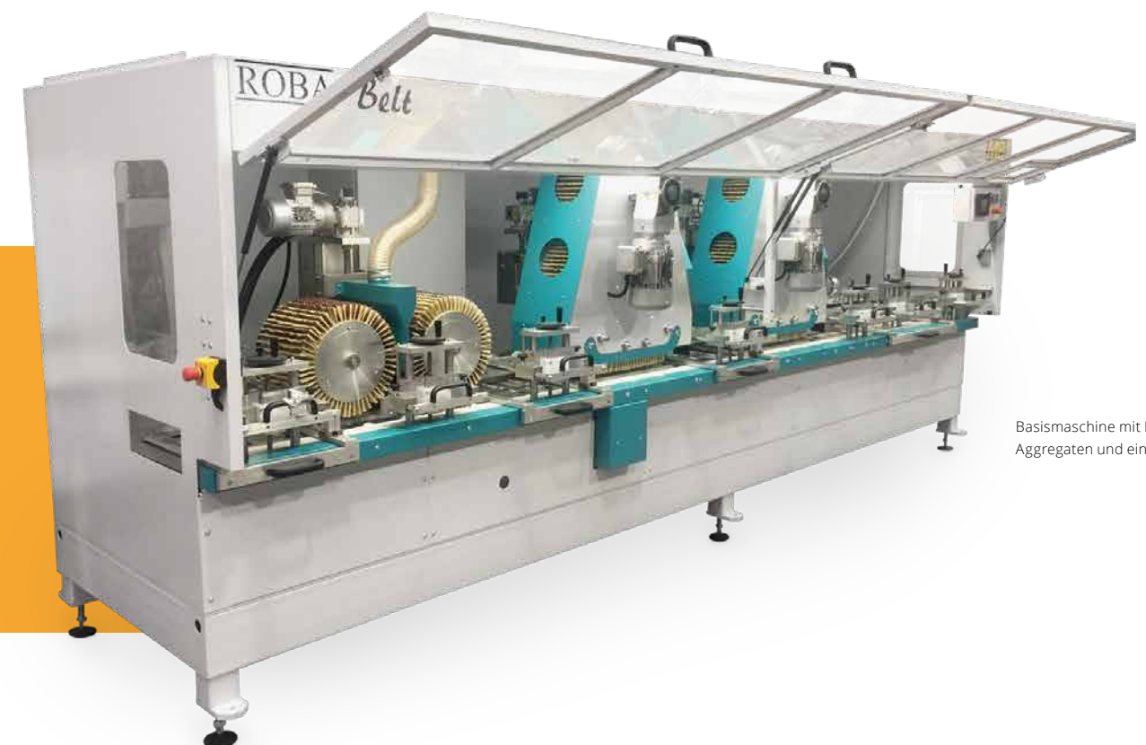
ROBA Belt Maschinenkonfiguration für die Bearbeitung von Fußbodenprofilen mit einem BA300 Bandschleifaggregat. Die SPS gesteuerte und motorische Oszillationsbewegung aller Aggregate berücksichtigt neben der Schleifband- auch die Werkstückbreite. Das stellt sicher, dass das Schleifpapier stets komplett genutzt wird.
