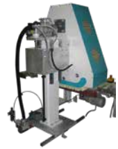
RB300 Aggregat mit motorischer Höhenverstellung und Oszillationseinheit
