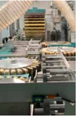
Doppelbürste im Gleichlauf und Gegenlauf schleifend
