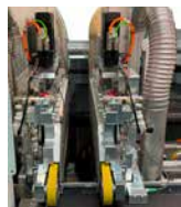
Linker und rechter Aggregat-Support mit je zwei HSK63 Frässpindeln.
