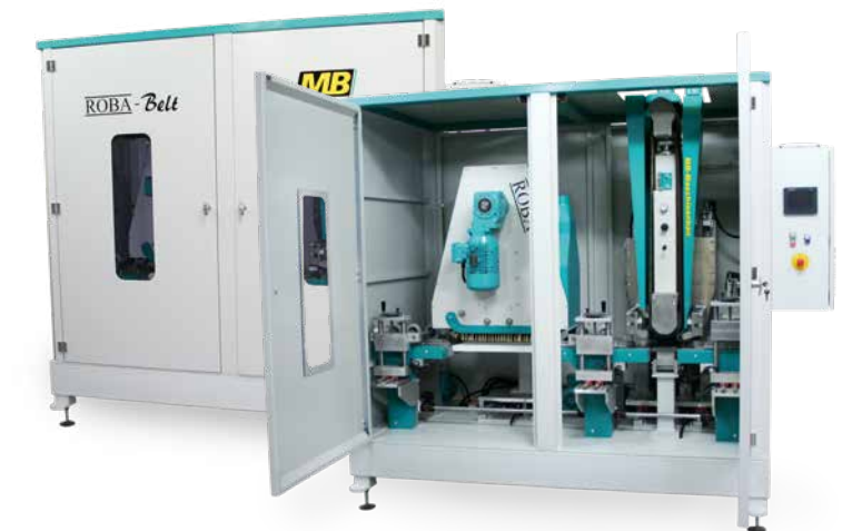
ROBA Belt Maschinenkonfiguration für die Bearbeitung von Fußbodenprofilen mit einem BA300 Bandschleifaggregat. Die SPS gesteuerte und motorische Oszillationsbewegung aller Aggregate berücksichtigt neben der Schleifband- auch die Werkstückbreite. Das stellt sicher, dass das Schleifpapier stets komplett genutzt wird.
