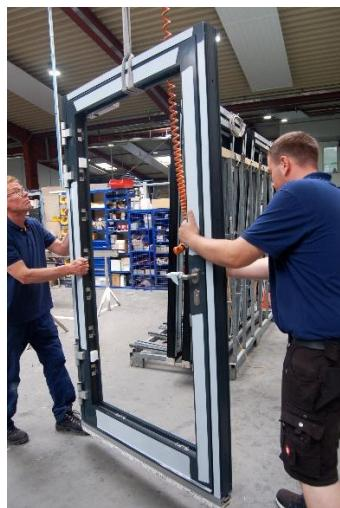
Als CE-zertifiziertes Unternehmen fertigt FOPPE+FOPPE normkonforme Brand- und Rauchschutztüren für die Außenanwendung. Im Programm sind neben der neuen EI<sub>2</sub>90 S<sub>a</sub>/S<sub>200</sub>C5-Tür auch Rohrrahmentüren in EI<sub>2</sub>30- und EI<sub>2</sub>60-Ausführung.
