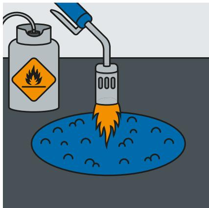
SWARCO PREFORMED mit dem Gasbrenner ganzflächig erhitzen – bis zur Blasenbildung an der Oberfläche.
