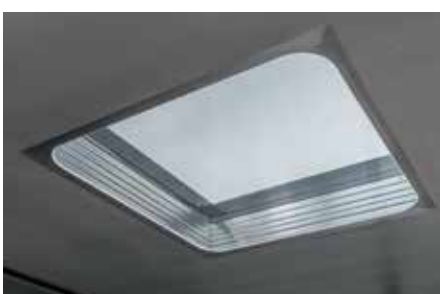
Deckenfenster, mehrfach verglast
