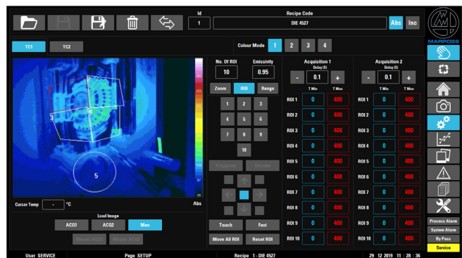
Wärmebilder mit Temperaturwerten für jeden Zielbereich und Parametern zur Rezepterstellung
