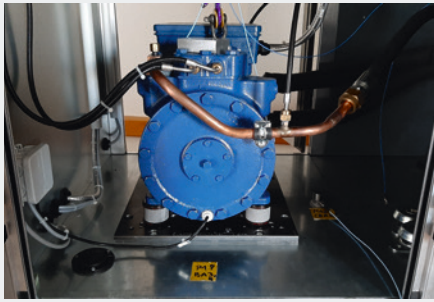
Lagerung eines Hubkolbenkompressors mit Isotop® MSN-DAMP
