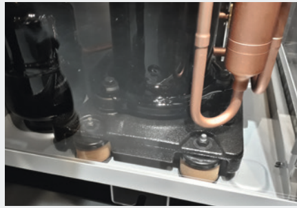
Lagerung einer Kompressorenbaugruppe auf einem Innenrahmen
